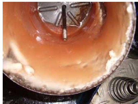
Figure 2. Wax 성분의 고체화 현상에 의한 연료필터 폐색 사례 (Source : CIMAC guideline, cold flow properties, 2015-01 1 st edition)
